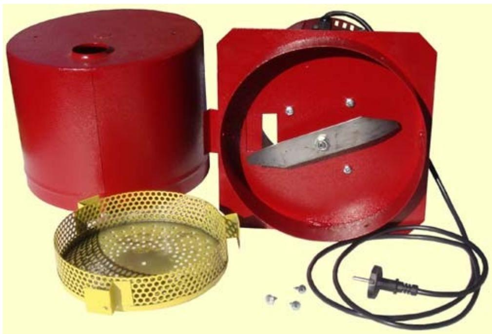
Загрузочная камера поз.1 смонтирована в корпусе поз.3 и предназначена для засыпки зерна и его подачи через подающее окно поз.7 в камеру измельчения поз.9.
